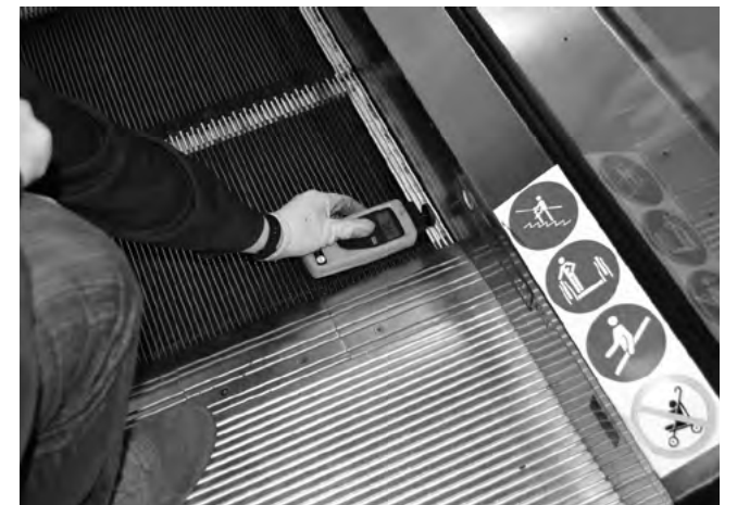
Рис. 3 Скорость движения несущего полотна эскалатора
