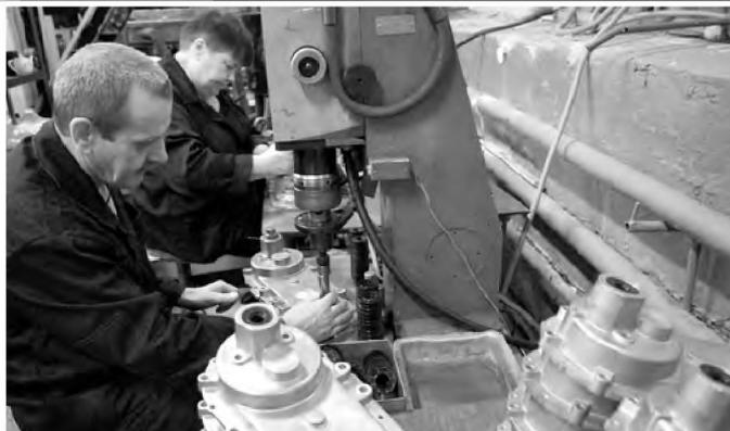
Цех21. Сборка редукторов для мотоблоков. В год на «Агате» их изготавливают около 10 тысяч единиц.
