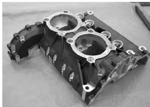
Часть блока цилиндров авиационного двигателя, по которым проводятся опытно-конструкторские работы на «Агате»
