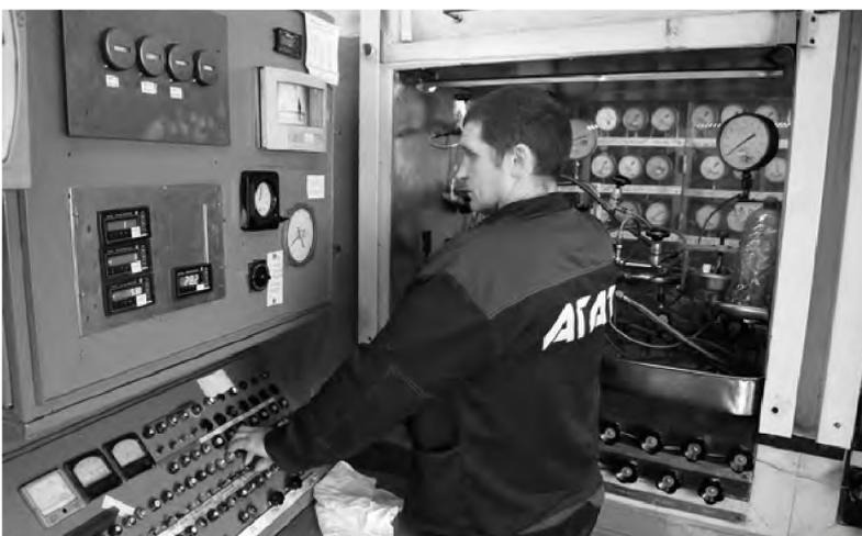
Цех 22. Испытания топливо-регулирующей аппаратуры агрегатов от авиационного двигателя. После сборки все агрегаты проходят испытания, согласно определенной методике для подтверждения характеристик годности продукции
