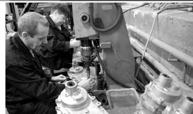
Цех 21. Сборка редукторов для моторблоков. В год на «Агат» их изготавливают около 10 тысяч единиц.
