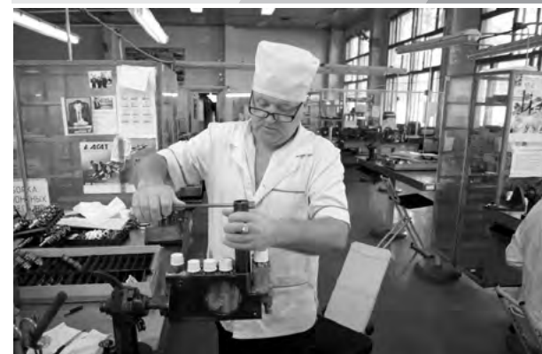
Участок сборки цеха 22. Все детали, которые изготавливаются стекаются на склад готовых деталей и потом выдаются на сборку. Здесь собирают серийные агрегаты для авиационных двигателей
