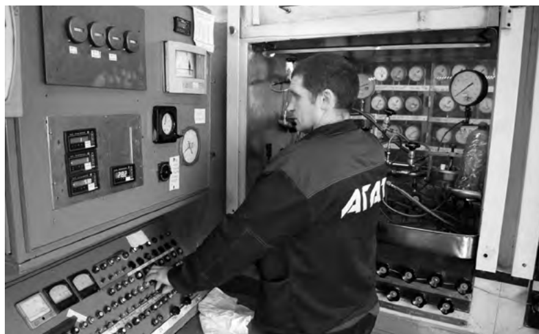
Цех 22. Испытания топливо-регулирующей аппаратуры агрегатов от авиационного двигателя. После сборки все агрегаты проходят испытания, согласно определенной методики для подтверждения характеристик годности продукции
