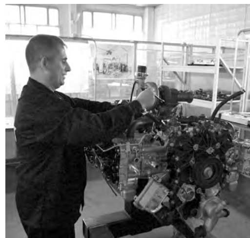
Сборка установки выхлопной системы для дизельного двигателя на опытном участке производства
